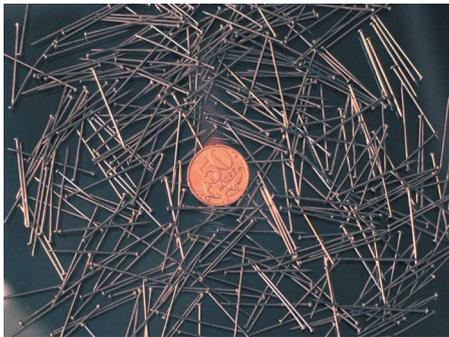
Рис.6. В качестве отражателей здесь использованы булавки
